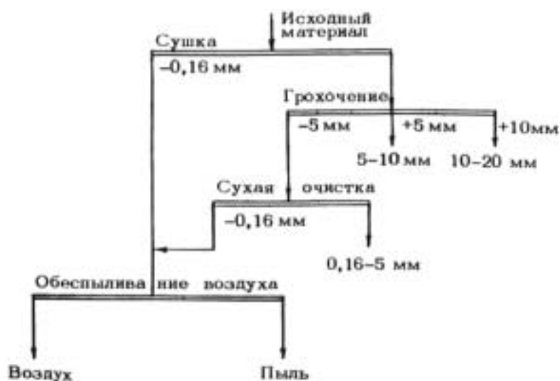
Рис. 7. Технологическая схема сухого обогащения влажных отсеков дробления
