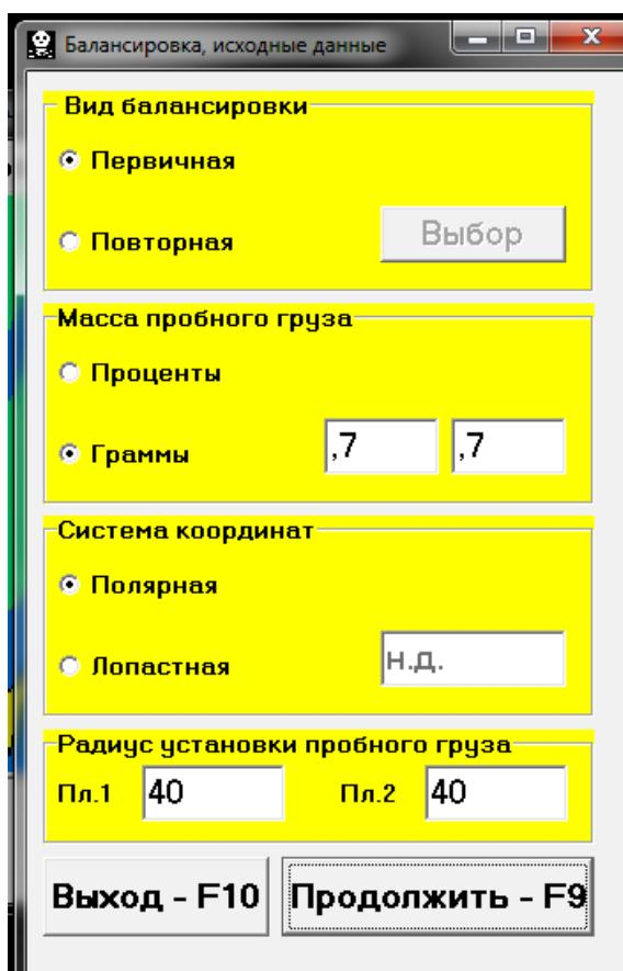
Рис. 7.13. Рабочее окно для ввода исходных данных при балансировке в двух плоскостях.
