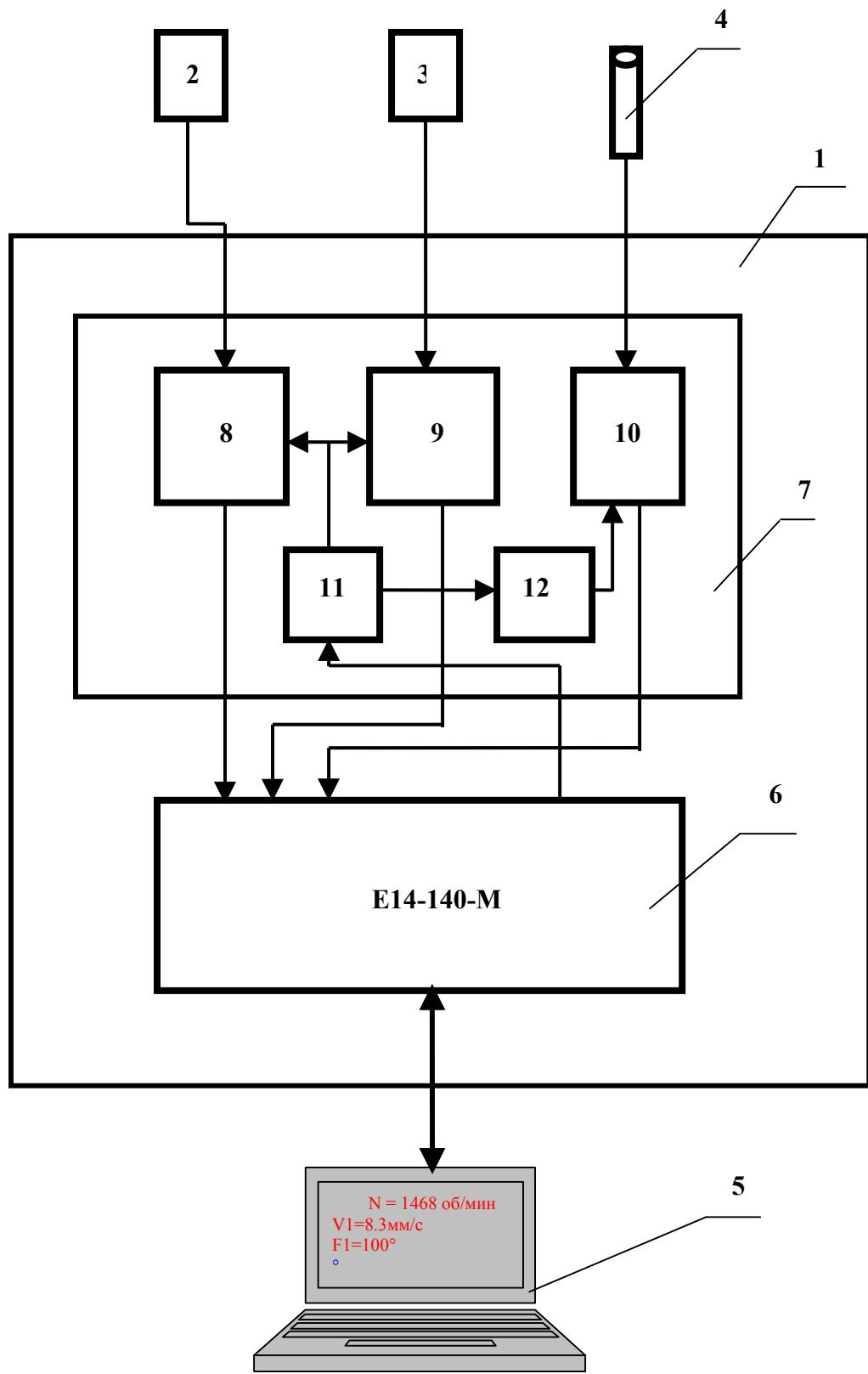
Рис. 4.3. Функциональная схема прибора «БалКом-1».
