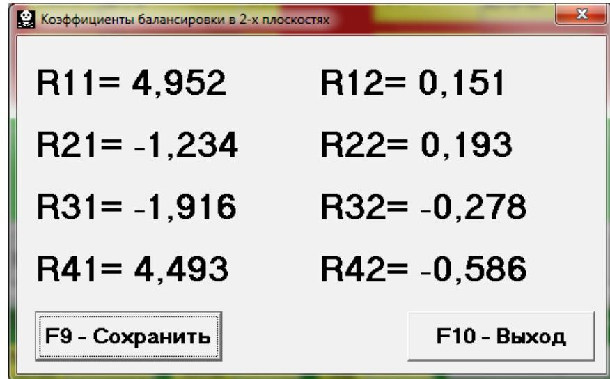
Рис. 7.16. Рабочее окно с коэффициентами балансировки в 2-х плоскостях.
