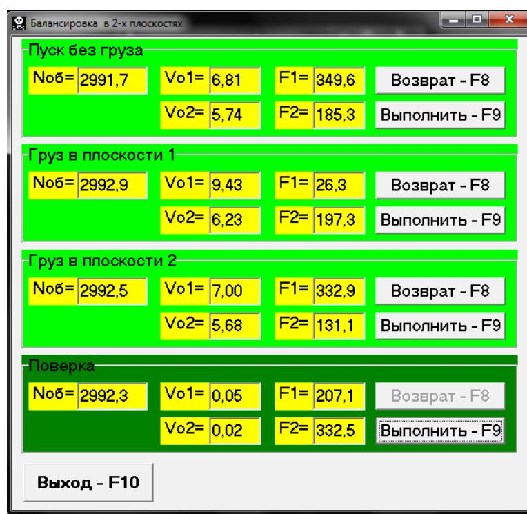
Рис. 7.14. Рабочее окно, используемое для измерений при балансировке в двух плоскостях.
