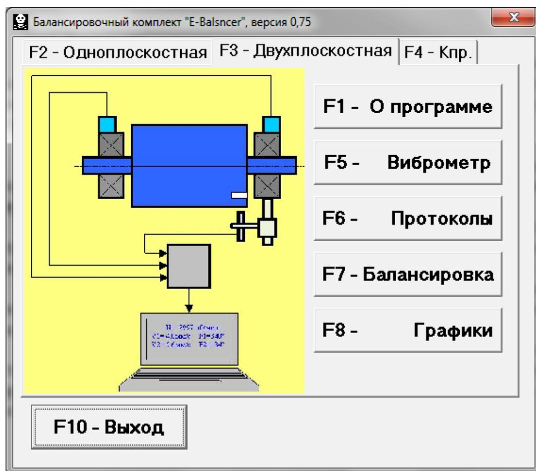
Рис. 7.2. Вид Главного рабочего окна программы «БалКом-1»
