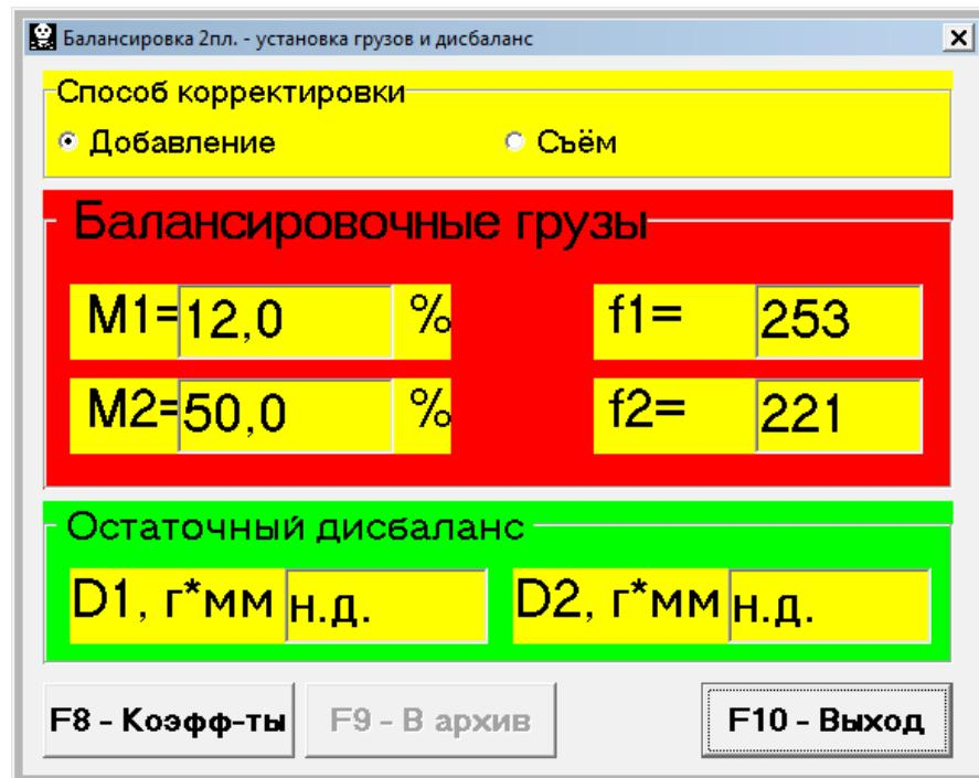
Рис. 7.15. Рабочее окно с результатами расчета параметров корректирующих грузов
