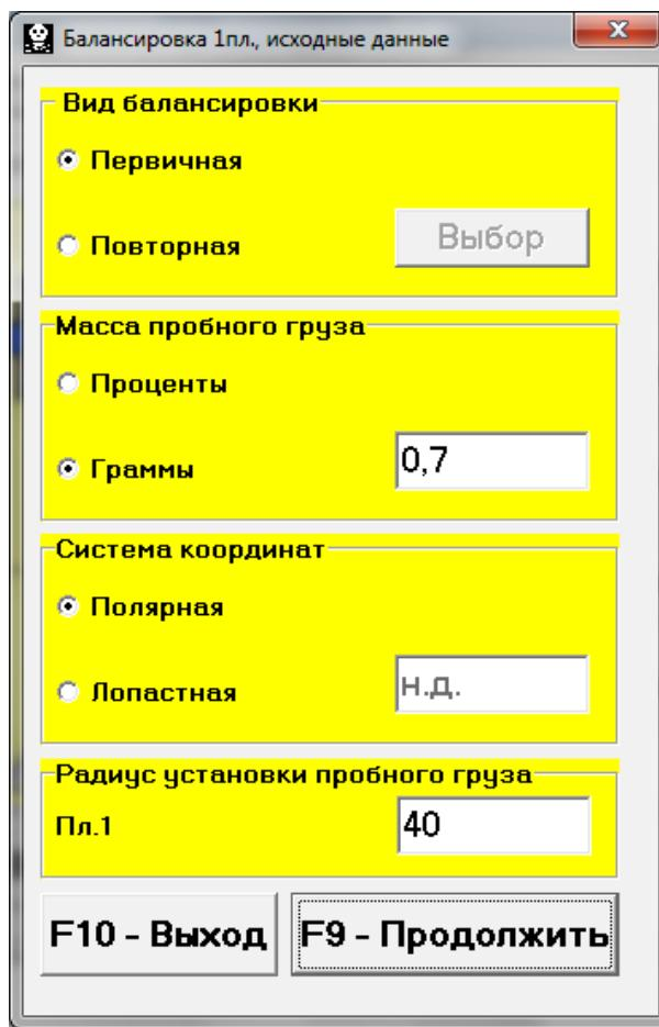
Рис. 7.5. Рабочее окно для ввода исходных данных при балансировке.
