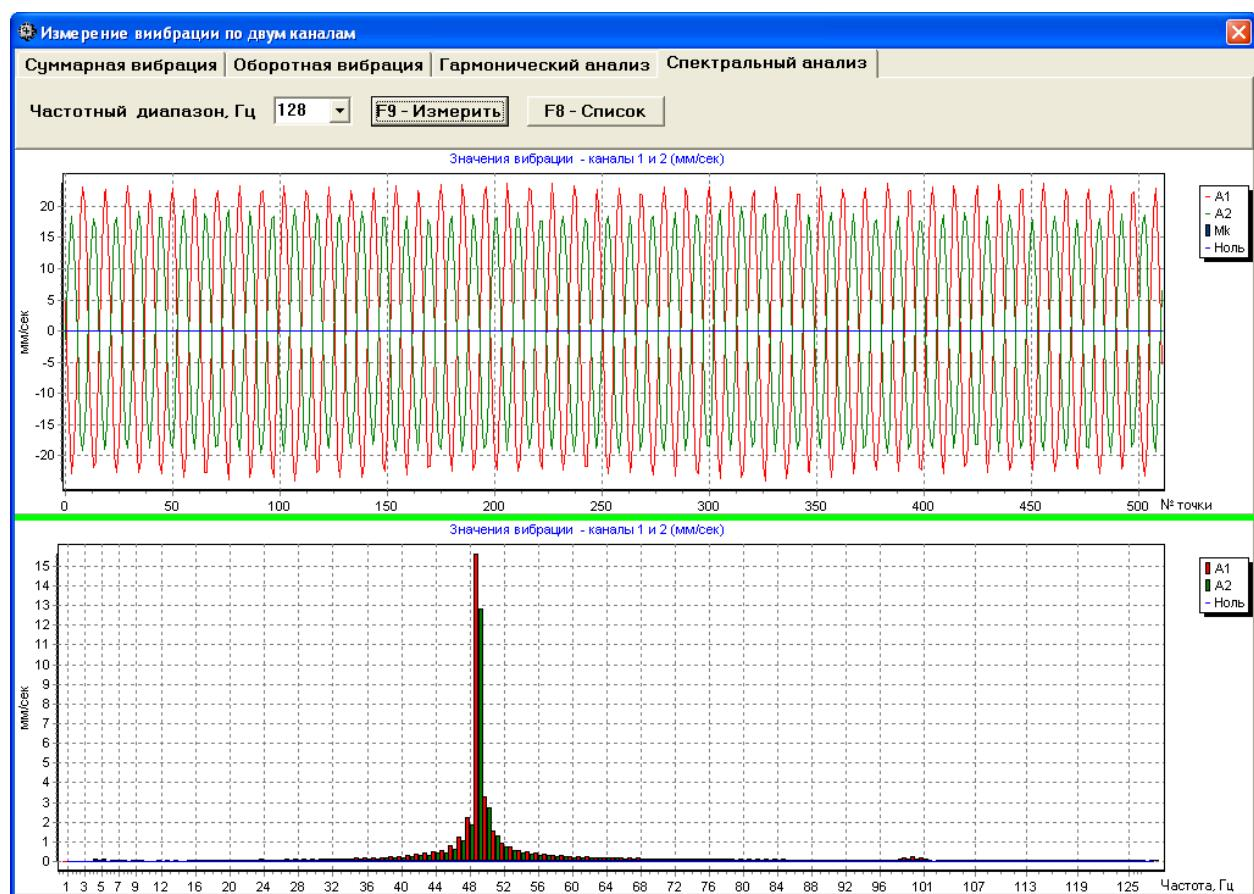
Рис. 7.23. Рабочее окно для вывода спектрального анализа вибрации.
